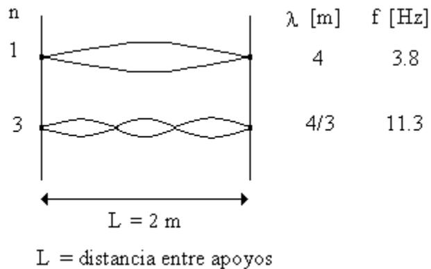
14. En un experimento de ondas se varió la frecuencia, se midió la longitud de onda ( $\lambda$ ) y se determinó el periodo ( $\tau$ ) correspondientes, obteniéndose la tabla que se muestra. Con base en ello, determine:
