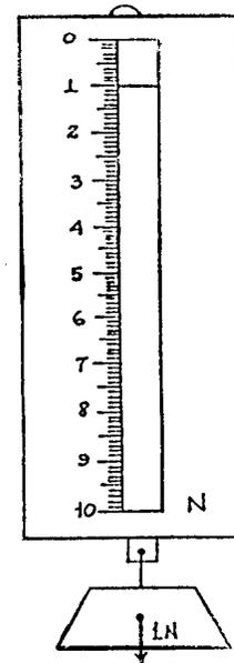
5. En un laboratorio de Física, en el cual la aceleración gravitatoria es  $9.78 \text{ [m/s}^2\text{]}$  se desea caracterizar una balanza; al medir nueve veces la masa de un peso patrón de  $20 \text{ [N]}$  se obtuvieron las lecturas que se muestran; adicionalmente se realizaron otras mediciones con otros pesos patrones.
