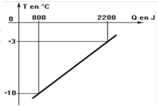
2. Para poder determinar la temperatura que se tiene dentro de una congeladora industrial, se tomaron cuatro trozos de hielo con diferentes masas, y se midió indirectamente la energía en forma de calor proporcionada, hasta que empezara a derretirse cada trozo. Los valores obtenidos se muestran en la tabla. Sabiendo que la capacidad térmica específica del hielo es  $c = 2260 \text{ J/(kg}\cdot\text{K)}$ , determine:
